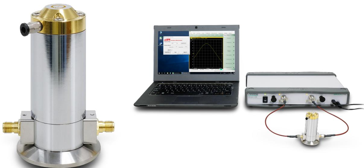
平坦な面を有するサンプルであれば、共振器の上に置くだけで非破壊の誘電率測定ができます。
