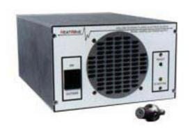
HWPES-250は、高電流のホローカソード装置で、制御さ れた電子電流を正確にプラズマ環境に流すことができま す。簡単スタート(高圧ではない)、安定した出力、連続 した可変放出電流、低ガスフロー条件、低動作温度、長 寿命などの特徴を持ち、いかなるメタル汚染物質にも出 力します。装置には電源、ケーブル、本体、取り扱い説 明書が含まれています。
